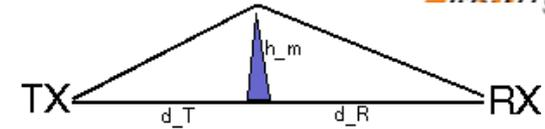
The diffraction parameter  $v$
